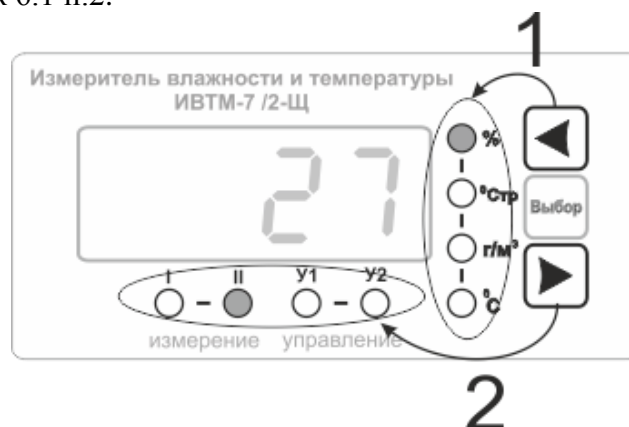
Рисунок 6.1 Схема функциональное назначение кнопок управления
